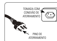
FIGURA 8.1 - CONEXÃO DO PLUGUE A TOMADA (MONOFÁSICO)
